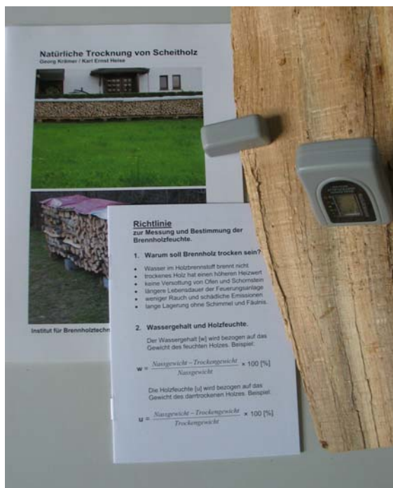
Abb. 1: Infopaket Scheitholz besteht aus: Info „Natürliche Trocknung von Scheitholz“, Richtlinie zur „Messung und Bestimmung der Brennholzfeuchte“ und Holzfeuchte-Messgerät.
