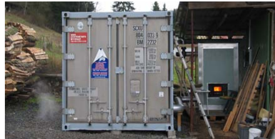
Abb. 1: Innovativ: Scheitholz-Containertrockner mit Warmluftofen und Umluft
