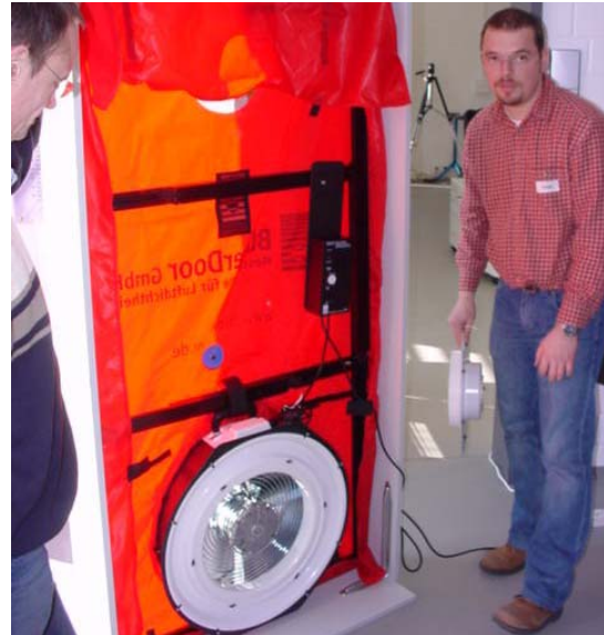
Abb. 1: Blower-Door Demonstration im PraxisHaus der HwK Potsdam
