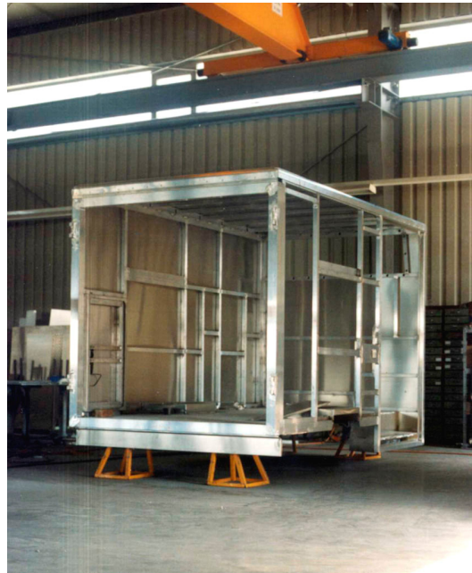
Wiederverwertbarer Wechselkoffer für Ambulanzfahrzeuge
