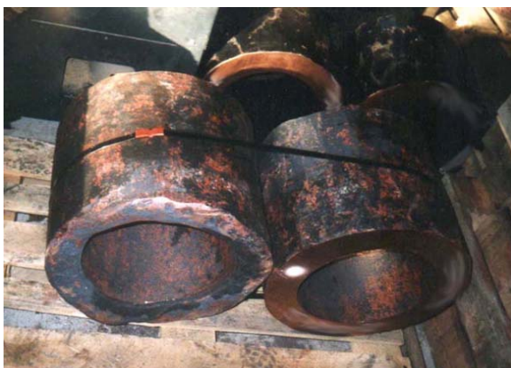
9-fach geschmiedete Buchsen vor und nach der Bearbeitung (linkes Bild) fertige Trennabschnitte der Buchsen (rechtes Bild)
