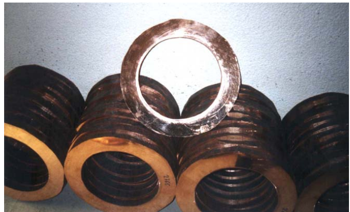
9-fach geschmiedete Buchsen vor und nach der Bearbeitung (linkes Bild) fertige Trennabschnitte der Buchsen (rechtes Bild)
