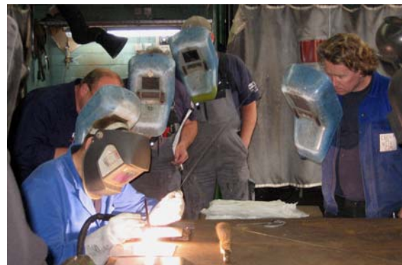
Abb. 1: Seminarteilnehmer lassen sich von einem Lehrschweißer während der Veranstaltung „Fehlervermeidung beim Schutzgas-schweißen von Aluminium“ Probeschweißungen unter bestmöglichen und im Vergleich dazu, unter unvorteilhaften Bedingungen vorführen.
