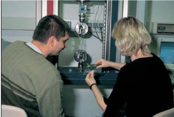
Abb. 2: Teilnehmer/innen eines Klebfachkraftlehrgangs bei der Prüfung von im Lehrgang gefertigten Zugscherproben
