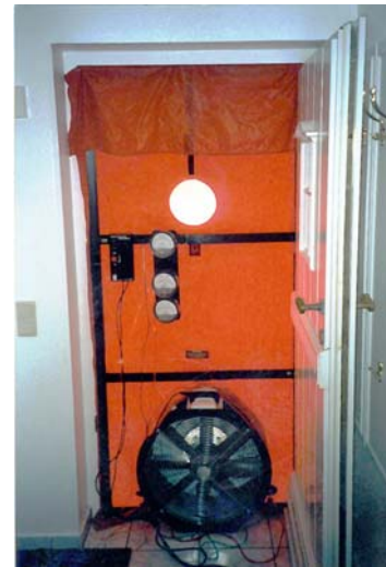
Demonstration einer Blower-Door-Messung
